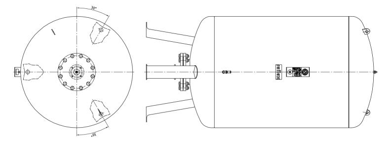
Druckausdehnungsgefäß refix DE 2000 l 10 bar – 70°C
